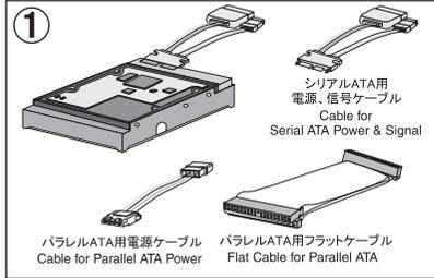
ハードディスクに電源ケーブル及び信号線を取り付けます。
