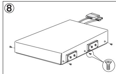
外部ケースのケース下部に蓋部分を合わせましたら、外部ケース用ネジを用いケースを固定して下さい。
