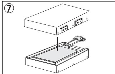
外部ケースのケース下部に蓋部分を取り付けます。(蓋部分を取り付ける際、IDEケーブル等をケース部分に挟まないようにお気を付け下さい。)
